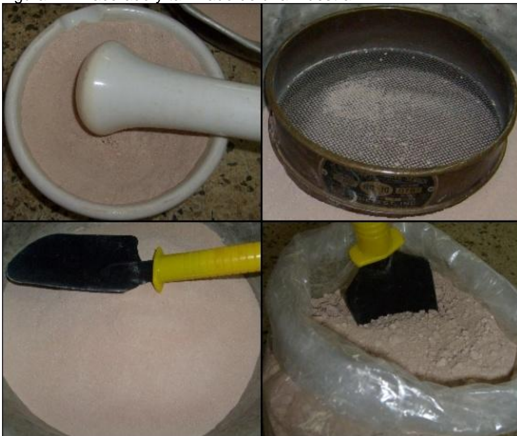
De izquierda a derecha y de arriba abajo: mortero con muestra macerada, tamiz número 10, muestra macerada y cernida, muestra sin procesar.
