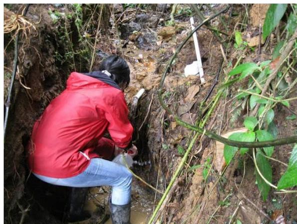
**Figura 6.** Aforo con método volumétrico
