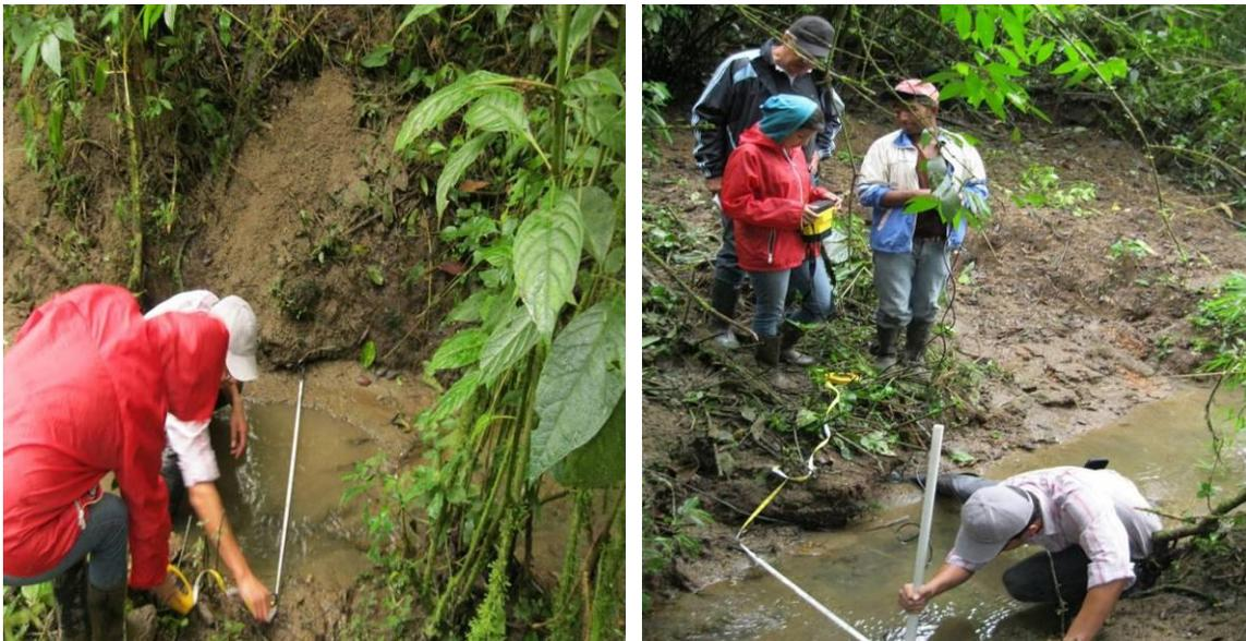
**Figura 8.** Aforo con el método velocidad-área
