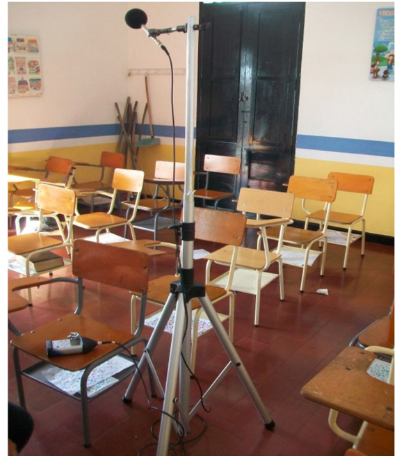
Figura 6. Medición de ruido interno en la I.E. San Agustín..
