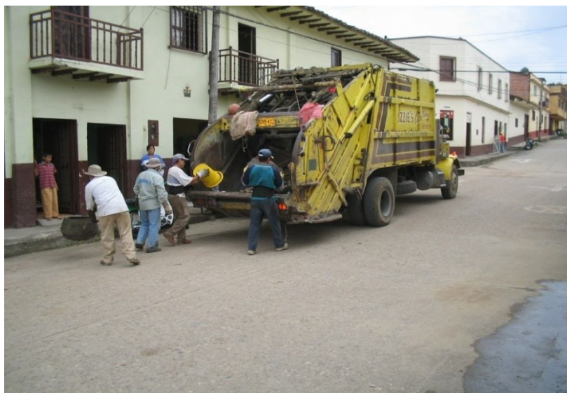
Figura 10. Vehículo compactador en el que se realiza la recolección y transporte de los R.S en el municipio de San Agustín.
