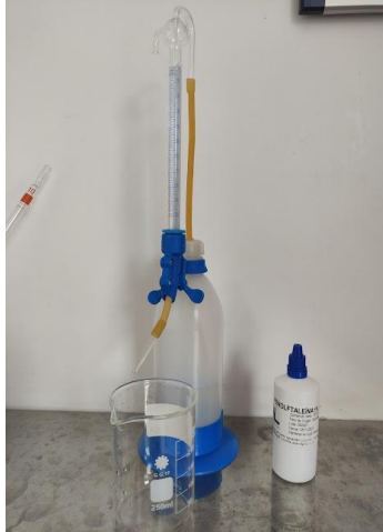
Ilustración 14. Verificación del buen funcionamiento del acidímetro para la leche.
