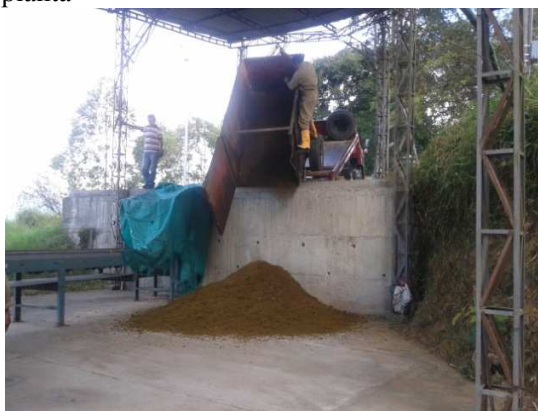
Figura 45. Descargue de residuo ruminal en la planta
