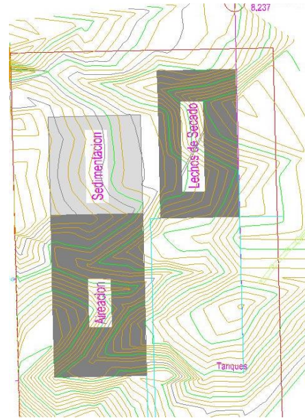
Figura 37. Localización unidades de la PTAR.
