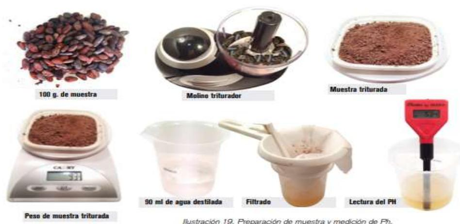
Ilustración 19. Preparación de muestra y medición de Ph.
