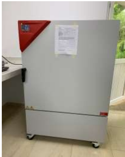
Imagen 4. Cámara de vida útil con control de T y Humedad relativa.
