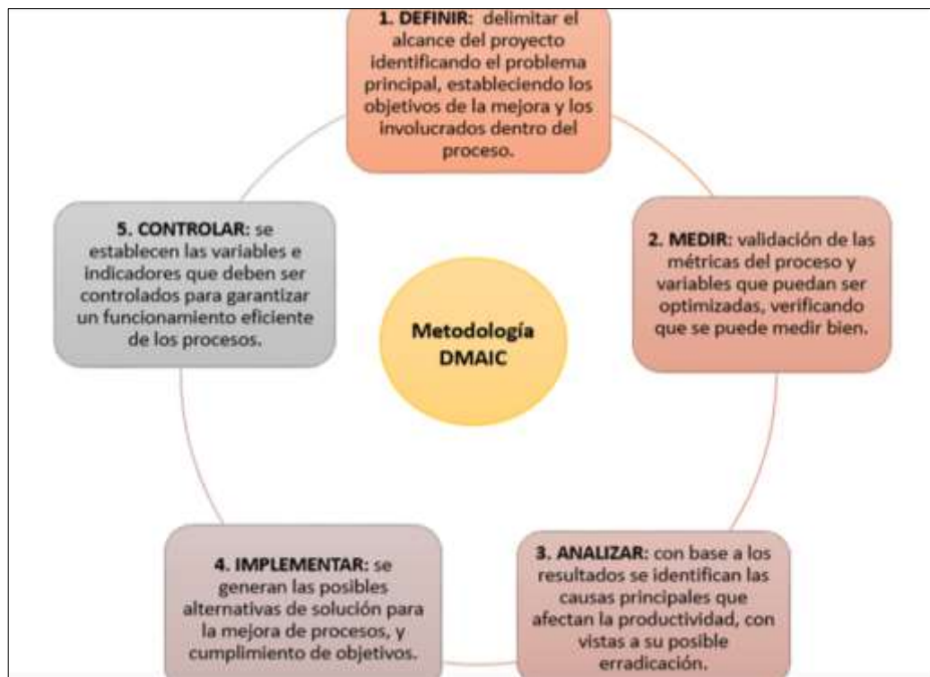
Figura 2. Ciclo de Funcionamiento DMAIC.
