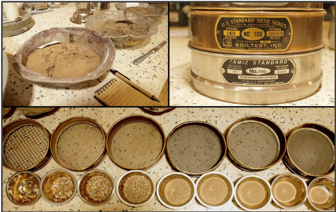
Prueba de granulometría por tamiza, Laboratorio de suelos.
