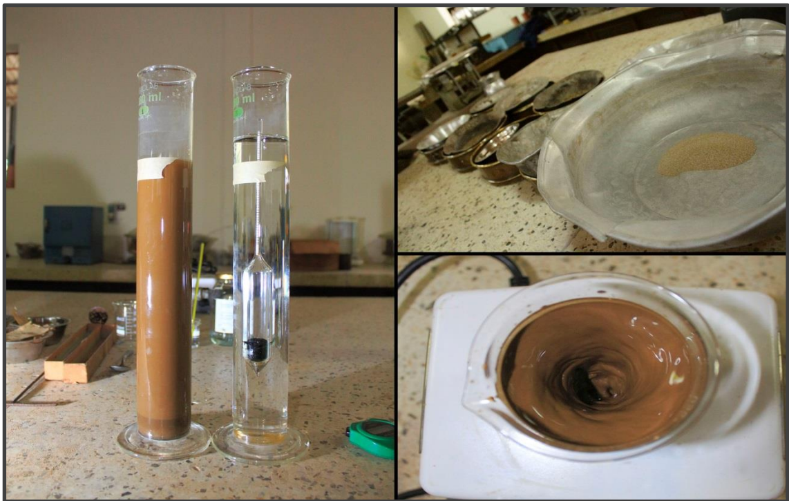
Prueba de textura método de Bouyoucos, Laboratorio de suelos.
