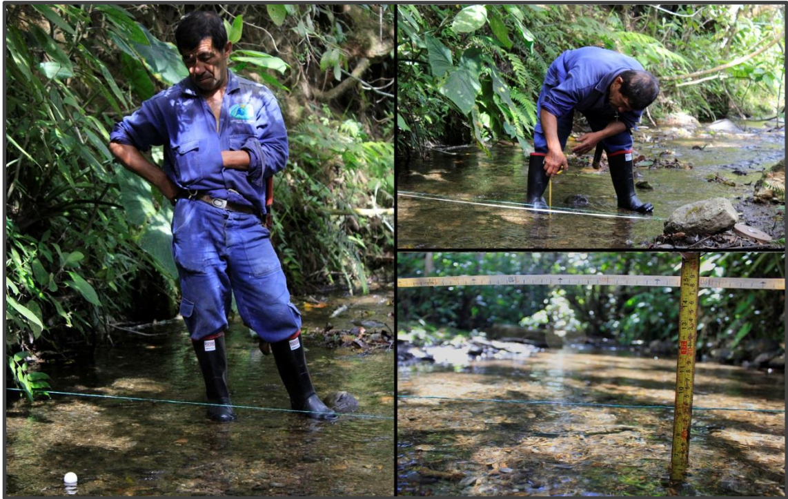
Aforo con flotador.
