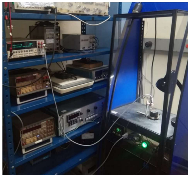
Figura 26. Fotografía del sistema de caracterización R(T) [fuente propia]
