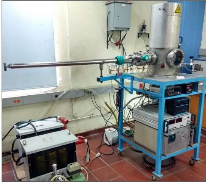
Figura 16. Equipo de sputtering DC y RF utilizado para el crecimiento de películas delgadas y bicapas a base de BFO y VO 2 Universidad del Cauca [fuente propia].
