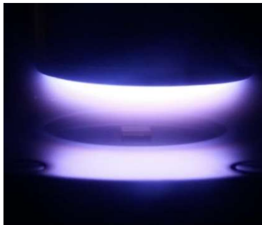
Figura 19. imágenes del proceso de a) acondicionamiento de los parámetros, b) y c) crecimiento de las películas delgadas y bicapas de \text{VO}_2 y BFO [fuente propia].
