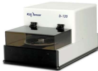
Figura 25. Fotografía del equipo de medición para realizar perfilometría
