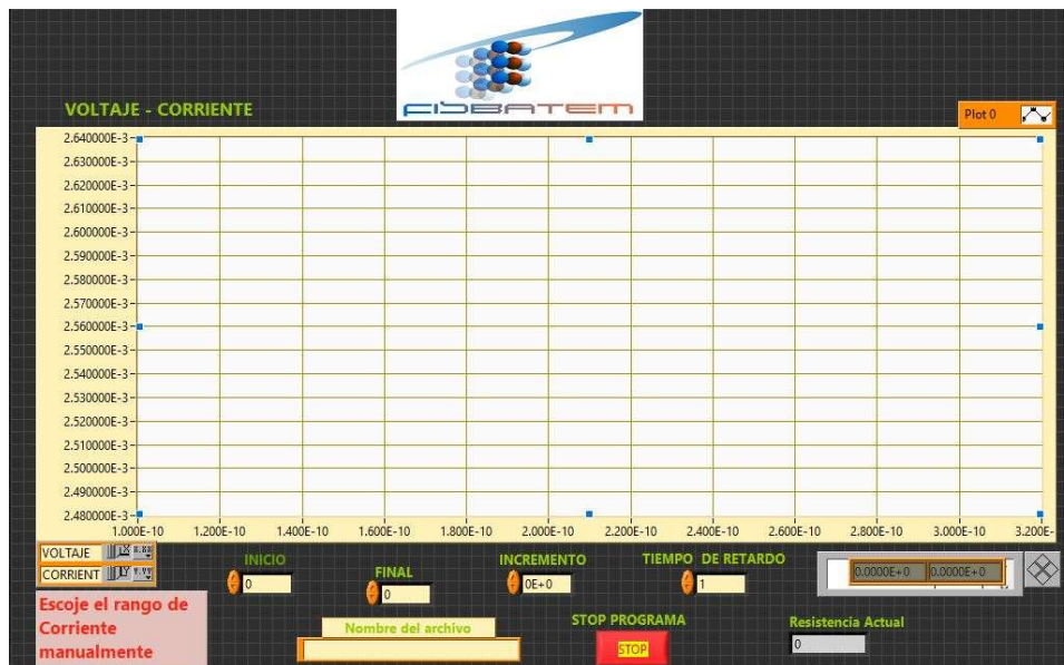
Figura 31. Panel frontal programa en Labview para realizar medidas I(V) o V(I) [Fuente propia].
