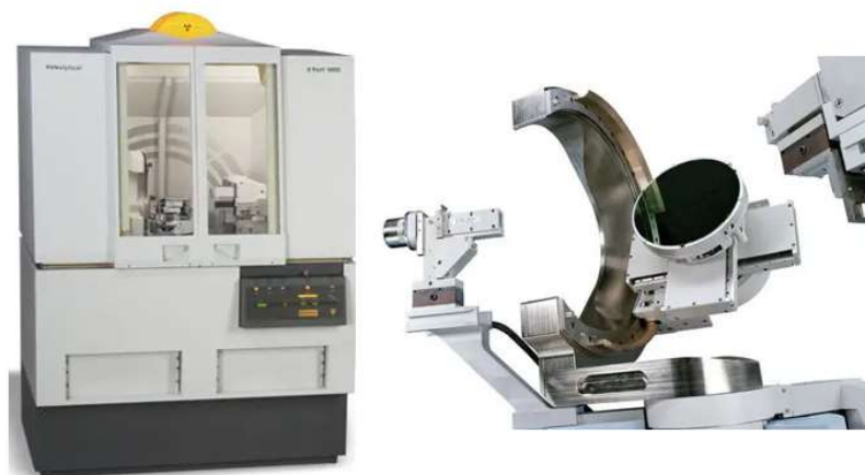
Figura 20. Fotografía del difractómetro D'Xpert PRO de la empresa PANanalytical, disponible en la Universidad del Valle
