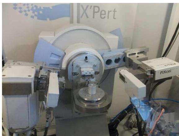
*Figura 3.8: Difractómetro de Rayos X*
