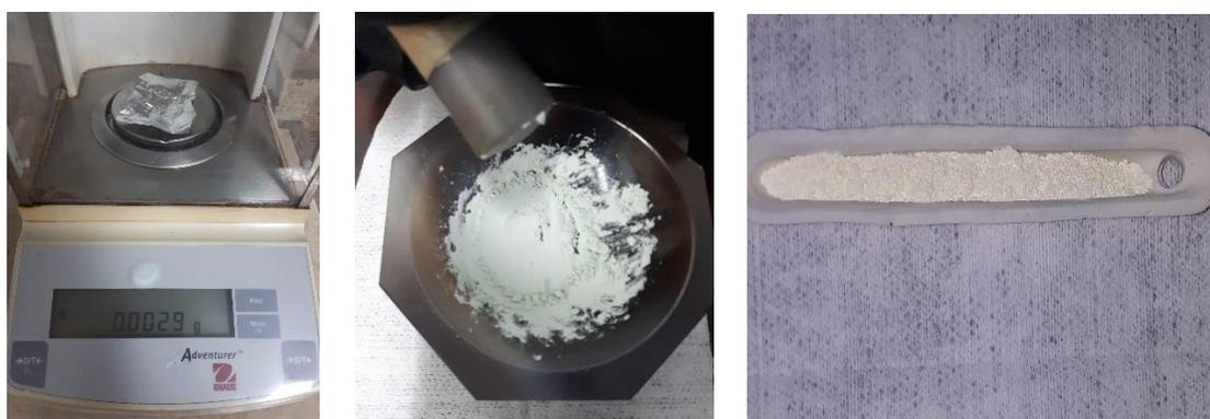
**Figura 3.1:** Balanza, mortero de ágata y porta muestra de alúmina.
