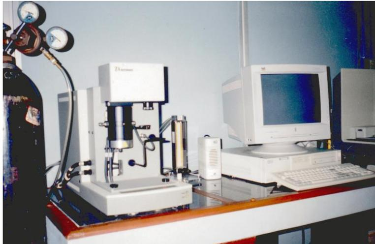
**Figura 12.** Analizador termogravimétrico (TGA) y estación de datos.
