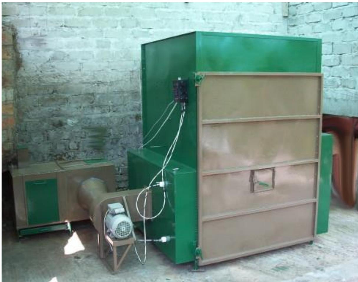
Tanto controlador, sensores y actuador fueron instalados de tal forma que permanezcan fijos en la planta, su interconexión o cableado es la parte que se puede remover en caso de ser necesario un traslado de la máquina o al momento del mantenimiento.
