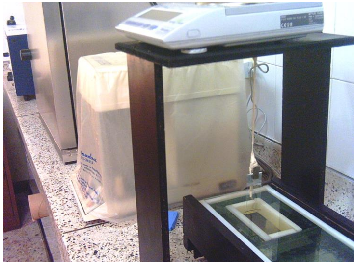
Figura 19. Montaje realizado para medir la tensión de superficie por medio de la técnica de Wilhelmy.
