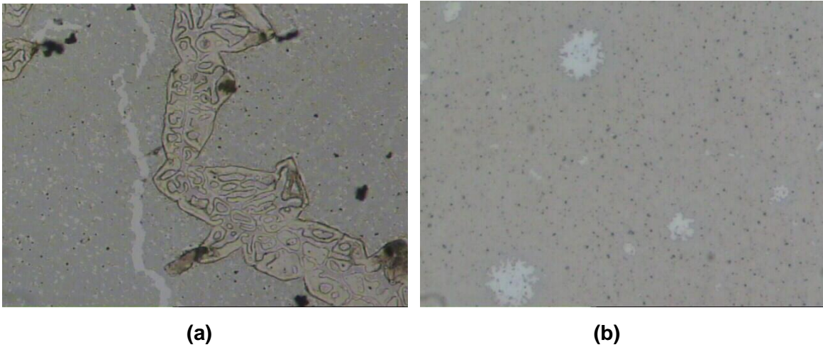
Figura 54. Fotografías tomadas con microscopía óptica de los sustratos con recubrimientos obtenidos de soluciones de hierro a pH 4 con monocapa dejados durante 4 días en reposo en la cubeta, (a) sin tratamiento térmico y (b) con tratamiento térmico a 300°C.
