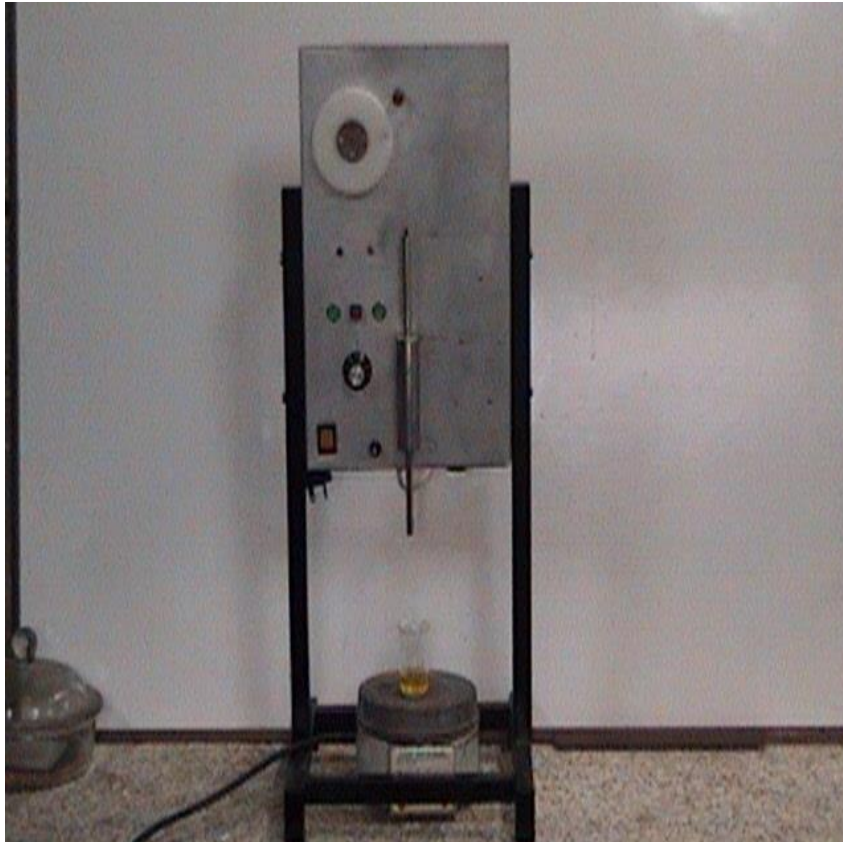
Figura 5.3 Equipo de inmersión, ascensor, para conformar los recubrimientos
