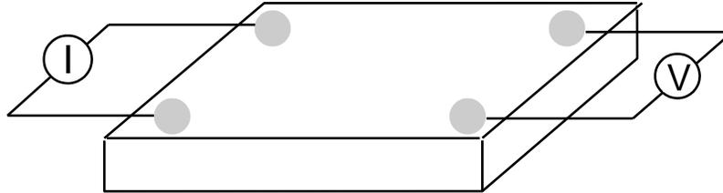
La resistencia se midió con una fuente programable Keithley 2400 configurada para operar con el método de las cuatro puntas
