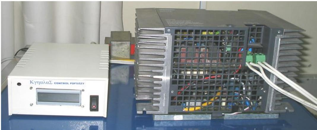
Para poder realizar un barrido controlado del campo magnético y observar el cambio de la resistencia que experimenta la película delgada de  $\text{VO}_2$  fue necesario implementar un controlador para la fuente de voltaje (equipo que se muestra en la parte izquierda de la figura 16).
