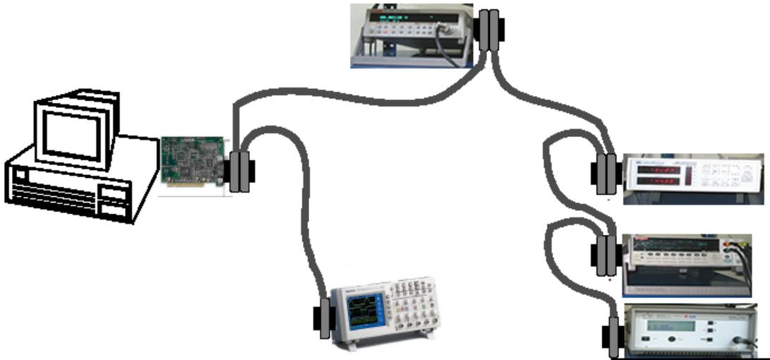
El dispositivo controlador (normalmente un PC dotado de una tarjeta GPIB) gestiona el flujo de datos y comandos a los diferentes elementos del sistema.
