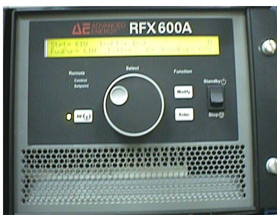
Figura. 20. Generador de R.F
