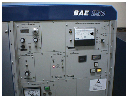
Figura. 19 Lector de presión del manómetro pirani en el sistema BAE250.
