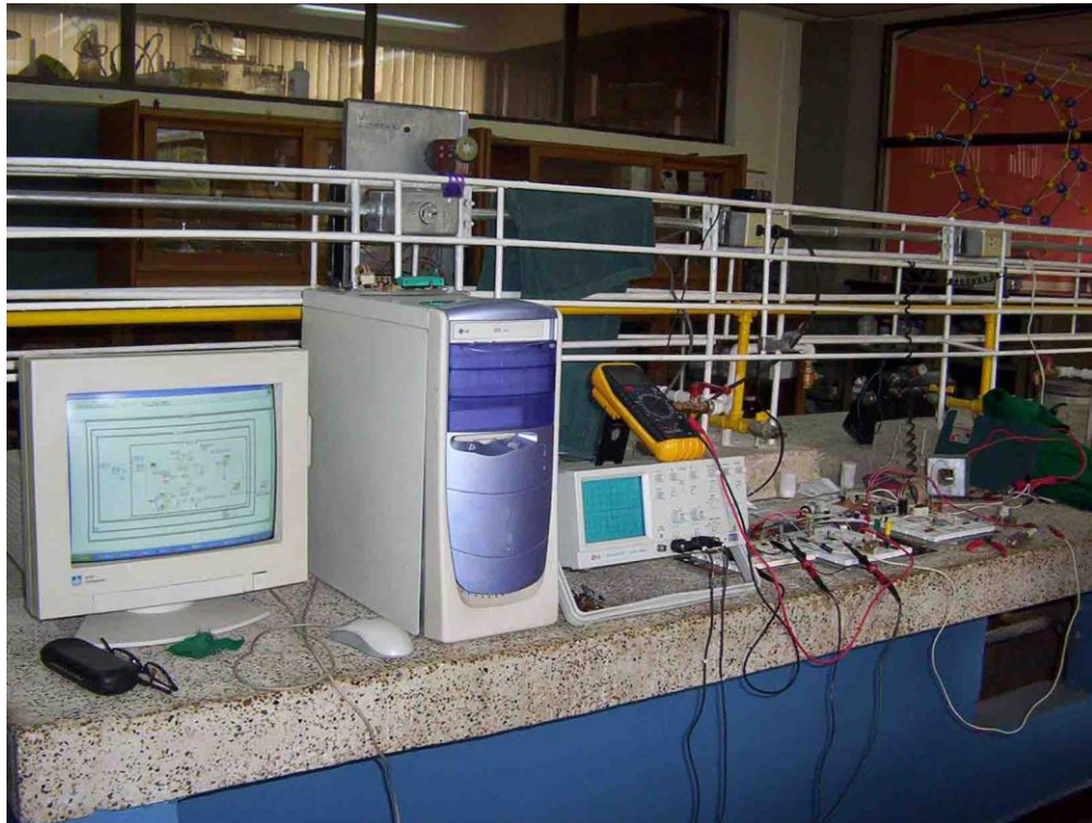
Figura 15. Equipo de medición de la constante dieléctrica en función de la frecuencia y la temperatura.
