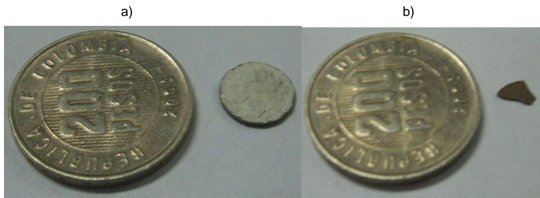
Figura 30. Muestras de BaTiO 3 . a) Tamaño de muestra original. b) Muestra empleada
