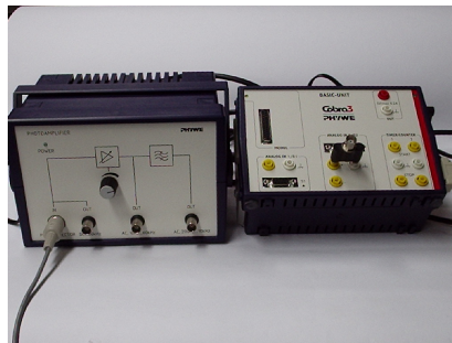
Figura 8.4: Unidad básica Cobra3 y módulo fotoamplificador
