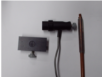
Figura 8.5: Sensor fotodiodo de silicio y abertura 30 \mu m
