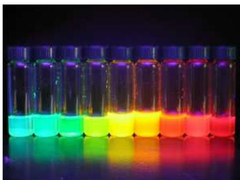
Figura 2.1: Nanocristales de Seleniuro de Cadmio en suspensión fluorescen bajo la luz ultravioleta. El color depende del tamaño de los nanocristales. Foto: Laboratorio de K. Jensen M. G. Bawendi C. Murray.
