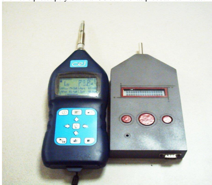
Figura 36 sonómetro prototipo y Casella 490 durante las pruebas realizadas.
