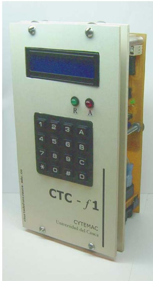
Figura 4.22. Controlador de temperatura CTC-f1 .
