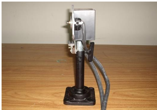
f. Vista lateral de la unidad de operación del chopper electromecánico
