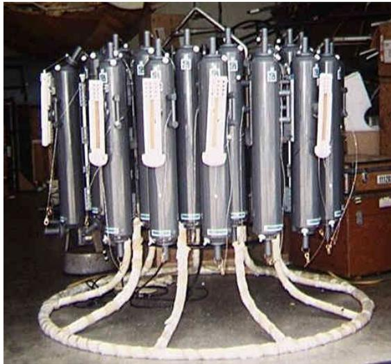
**Figura 7.** Sistema para usarse en aguas profundas, tiene 24 botellas Niskin y marcos para termómetros reversibles
