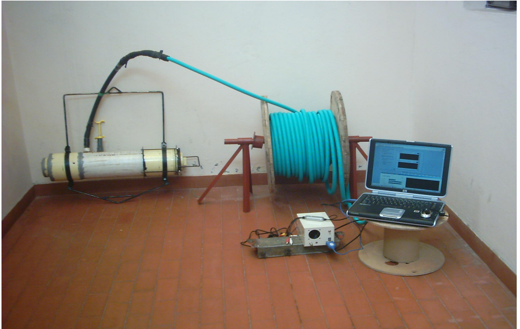
Figura 5.2: Sistema de monitoreo subacuático multisensorial para lagunas cratéricas
