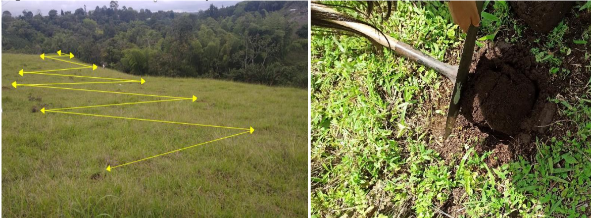
Figura 10. Recorrido en el lote y toma de muestras de suelo para su análisis.
