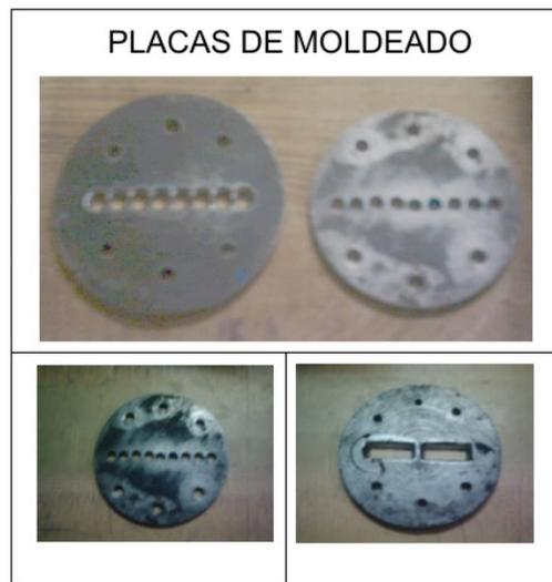
**Figura 5.2.** Placas de Prensado
