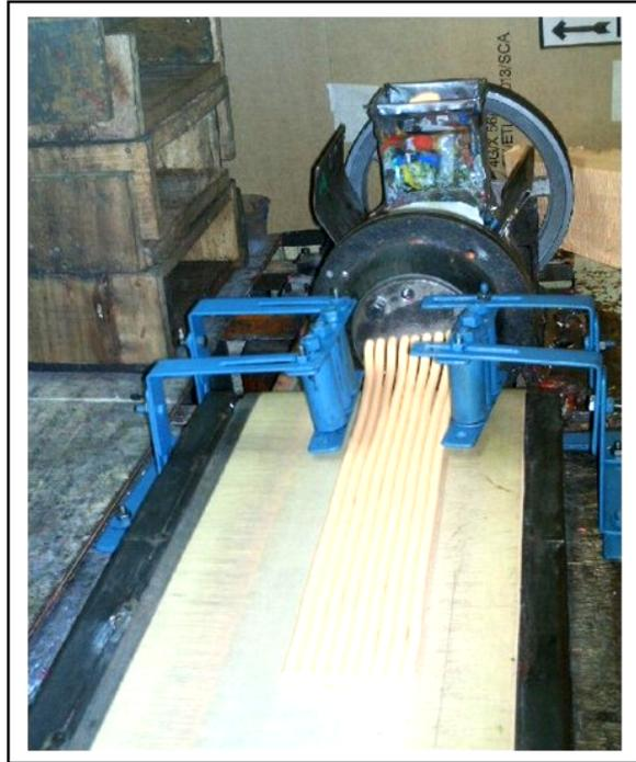
**Figura 5.8.** Equipo guía para producción de plastilina
