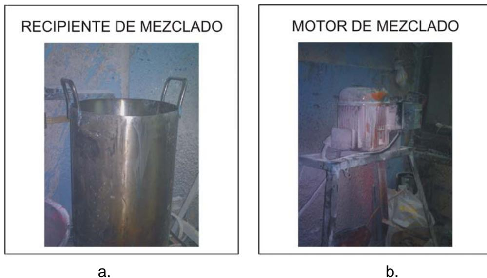
**Figura 6.10.** Equipo de preparación de crayones. 6.10a recipiente donde se mezcla las materias primas del crayón. 6.10b motor mezclador
