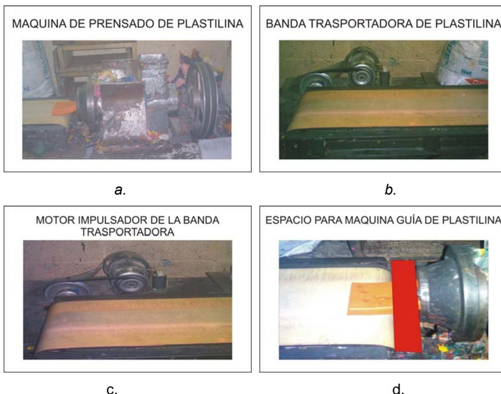
**Figura 5.1.** Equipo de prensado de plastilina 5.2a Maquina de prensado, 5.2b Banda transportadora, 5.2c Motor para banda transportadora y 5.2d Espacio disponible
