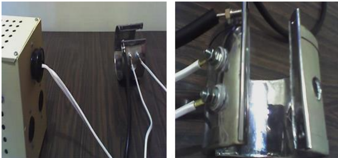
Figura 4.15 Conexión de una de resistencia al controlador de temperatura.
