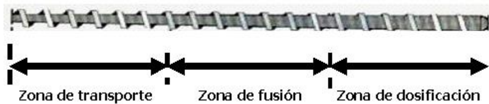
Figura 1.2 Esquema de un tornillo simple de extrusión.
