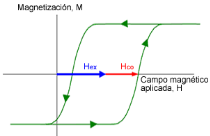
Figura 16. Ciclo de histéresis para un sistema con anisotropía de intercambio.
