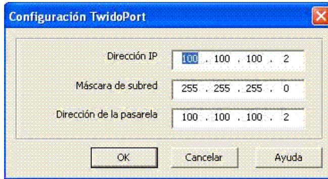
Figura 5.2.11. Configuración de la dirección IP para el PLC.
