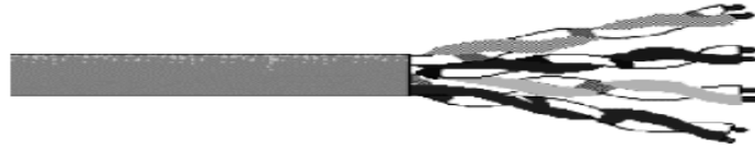
Figura 2.5.4. Estructura del Cable UTP.
