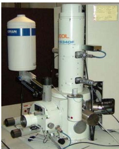
**Figura 5.4.-** Microscopio Electrónico de Barrido.
