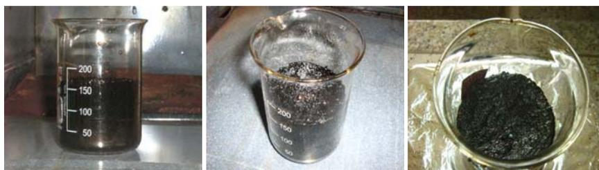
**Figura 6.28.-** Sólido final del sistema  $\text{SnO}_2$  - TBT obtenido por el método de precursor polimérico.
