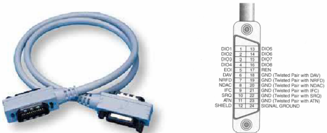
Figura 2: cable de conexión GPIB: aspecto físico y distribución de señales.
