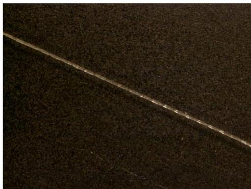
**Fig.10.** Imagen de LPFG (40 puntos), tomada con estereoscopio (ampliación: 1x).
