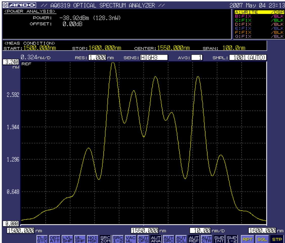
**Fig.19.** Espectro de transmisión obtenido a través del OSA para LPFG de 20 puntos.
