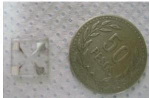
**Figura 3.1.** Sustrato con un capa plana evaporada de plata.
