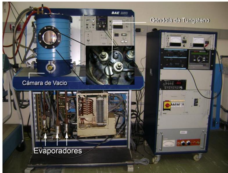
**Figura 3.4** Sistema de evaporación.
