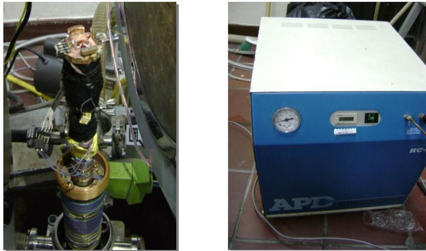
**Figura 3.8.** Horno calefactor del criostato (izq), criostato de circuito cerrado de Helio (der).
