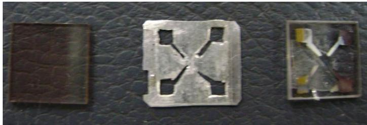
**Figura 3.3.** Mascara de Aluminio para la creación del diseño experimental.
