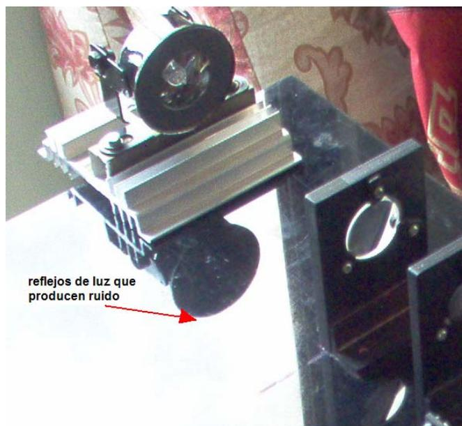
**Figura 4.11.** Pulido de las superficies para disminución de reflejos causados por la superficie liza de las bases
