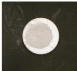
**Figura 68. Muestra sinterizada de Na- $\beta$ -alúmina, con electrodo de Pt utilizada que se utilizó para realizar el análisis con EI.**
