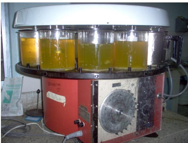
Figura 4.2. Equipo utilizado para realizar deshidratación y aclaración.
