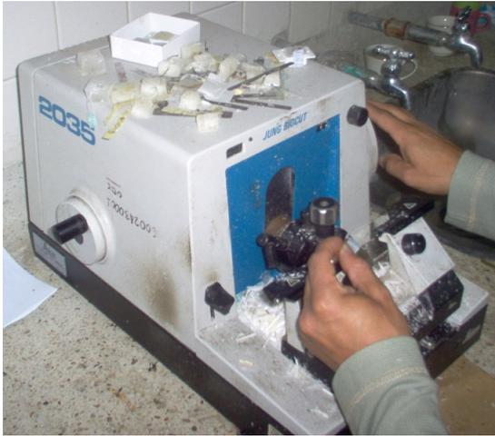
Figura 4.4. Microtomo: para realizar finos cortes.
