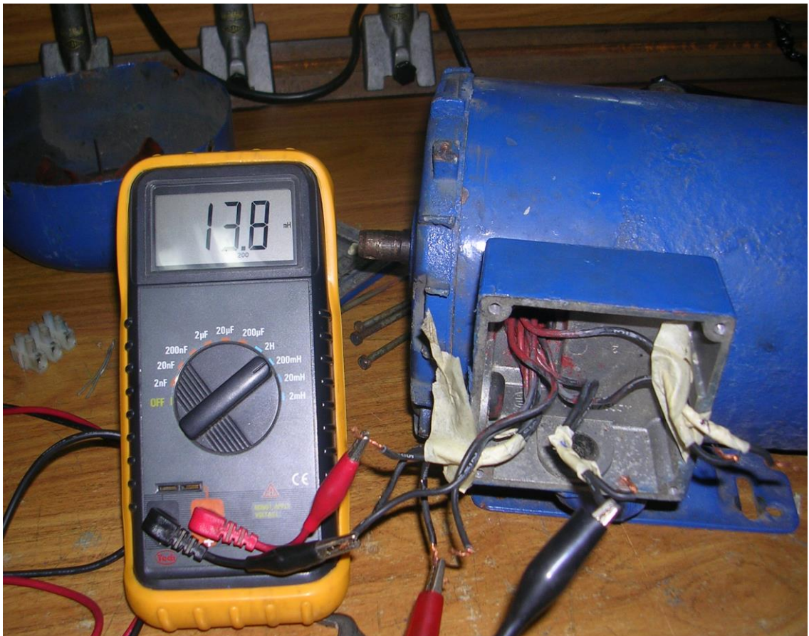
Figura 34. Mutua inductancia entre las bobinas del estator.
