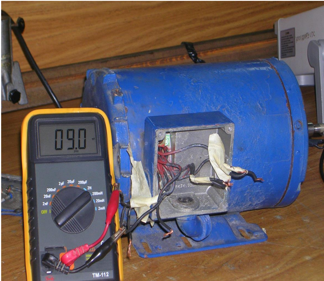
Figura 31. Medición de inductancias del estator.
