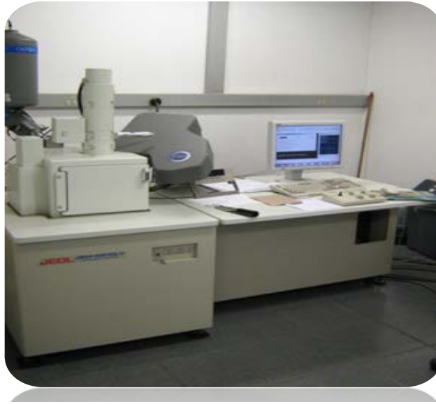
Figura 5.9. Fotografía del equipo JEOL 5910LV SEM utilizado para la caracterización microestructural de las piezas conformadas durante el desarrollo del trabajo
