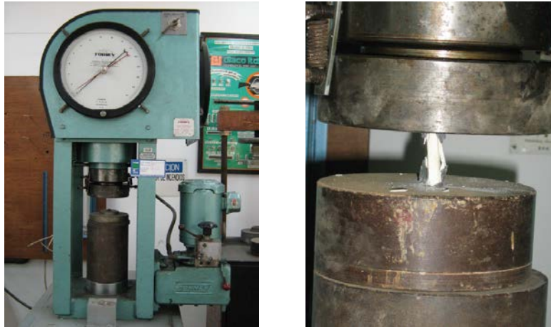
Figura 5.17. Montaje utilizado para realizar el ensayo de resistencia a compresión
