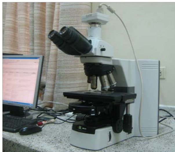
Figura 5.1. Microscopio óptico Nikon SM 2T con una cámara CCD acoplada utilizado para observar las piezas conformadas en este trabajo, (Unidad de Microscopía Electrónica-
