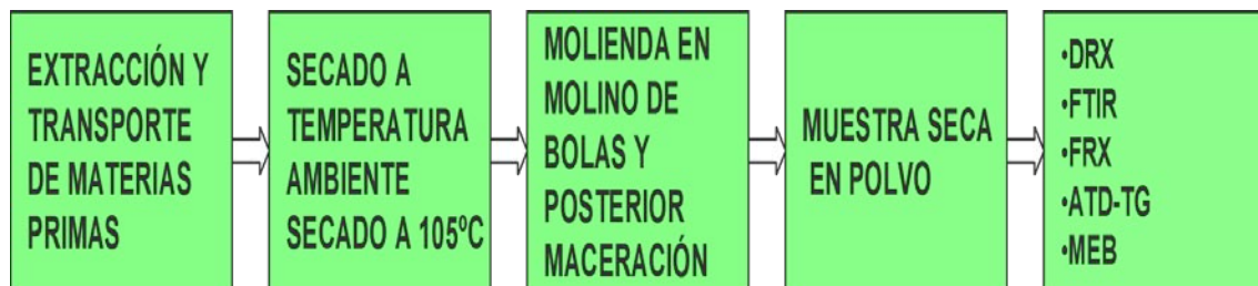
Figura 3.9. Esquema de preparación de las materias primas para sus pruebas de caracterización química
