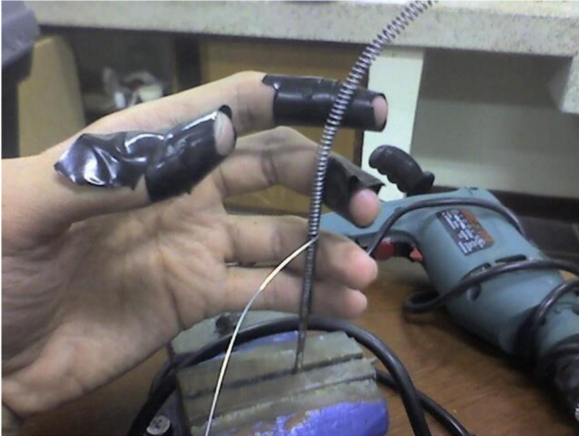
Figura 4.15. Ilustración del proceso de construcción de resistencia calefactora.
