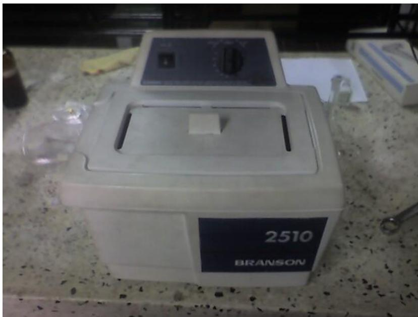
Figura 3.5. Equipo de ultrasonido utilizado para la limpieza de los sustratos, y del material utilizado para manipularlos, así como las mascararas de aluminio.
