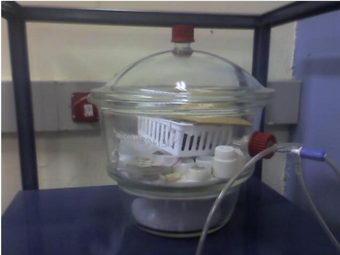
Figura 3.10. Cámara al vacío empleada para guardar las películas de SnO<sub>2</sub> conformadas y que constituyen el material activo del sensor de gases.
