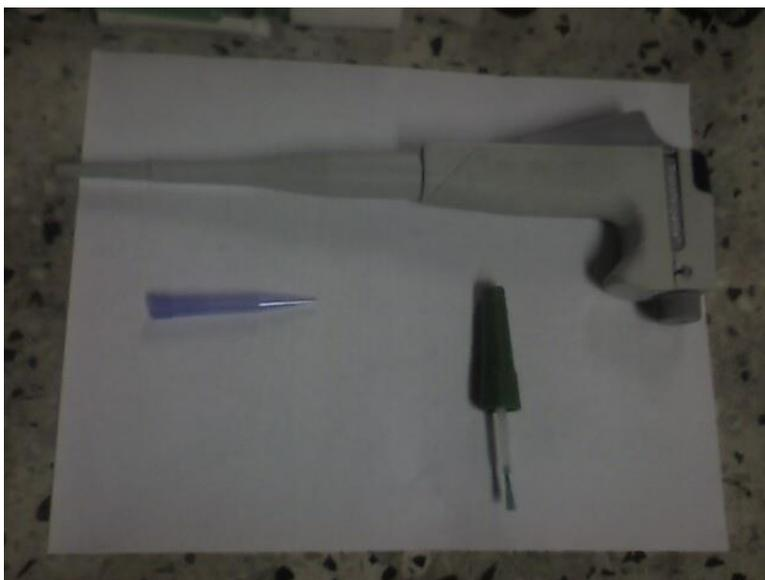
Figura 3.7. Micropipeta, punta y brocha, utensilios utilizados en la obtención de la suspensión rica en sólidos.
