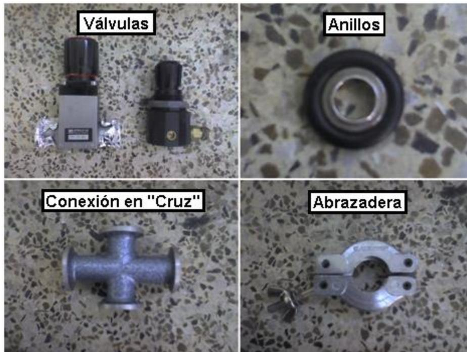
Figura 4.13. Diferentes aditamentos importantes para el equipo alternativo:
