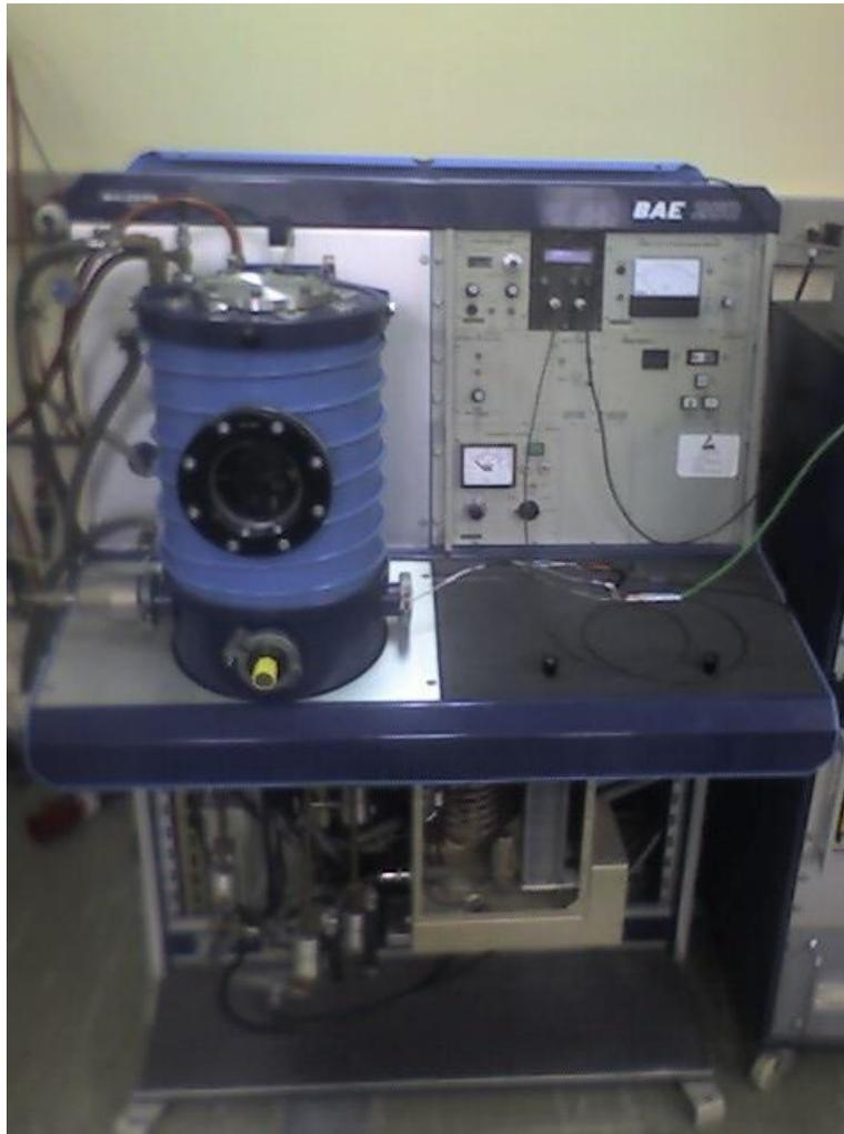
Figura 4.12. Equipo BAE 250 de la marca Balzer que contiene el sistema de vacío utilizado en el equipo alternativo.
