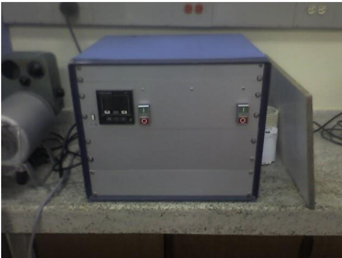
Figura 3.9. Horno utilizado para realizar los tratamientos térmicos de las películas de SnO<sub>2</sub> depositadas sobre sustratos de vidrio que contienen los electrodos de Ag respectivos.
