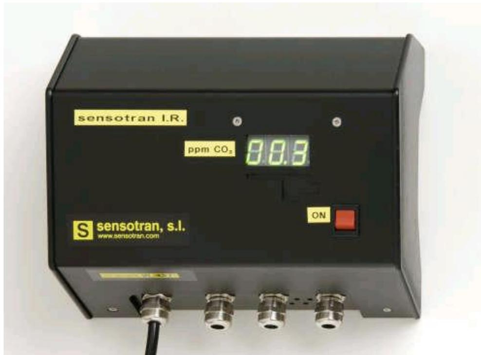
Figura 2.11. Analizador por infrarrojo.
