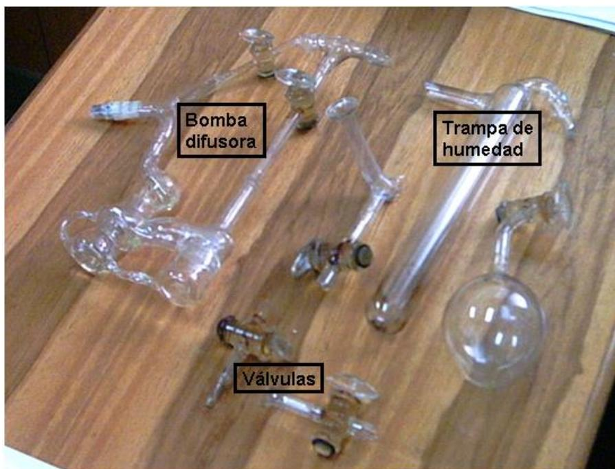
Figura 4.5 Partes del sistema en vidrio montado: bomba difusora, válvulas y trampas de humedad.
