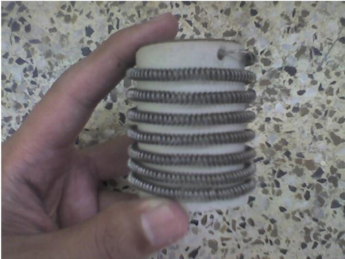
Figura 4.17 Fotografía que muestra la resistencia de Kanthal rodeando el cuerpo del horno.
