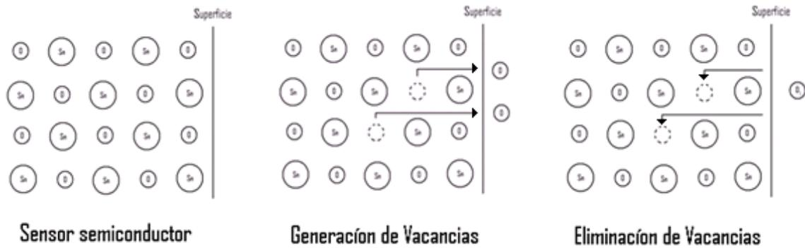
FIGURA 3.1 Procesos de sorción, desorción y absorción de oxígeno respectivamente, que se utilizan para justificar la variación de la resistividad del sensor.
