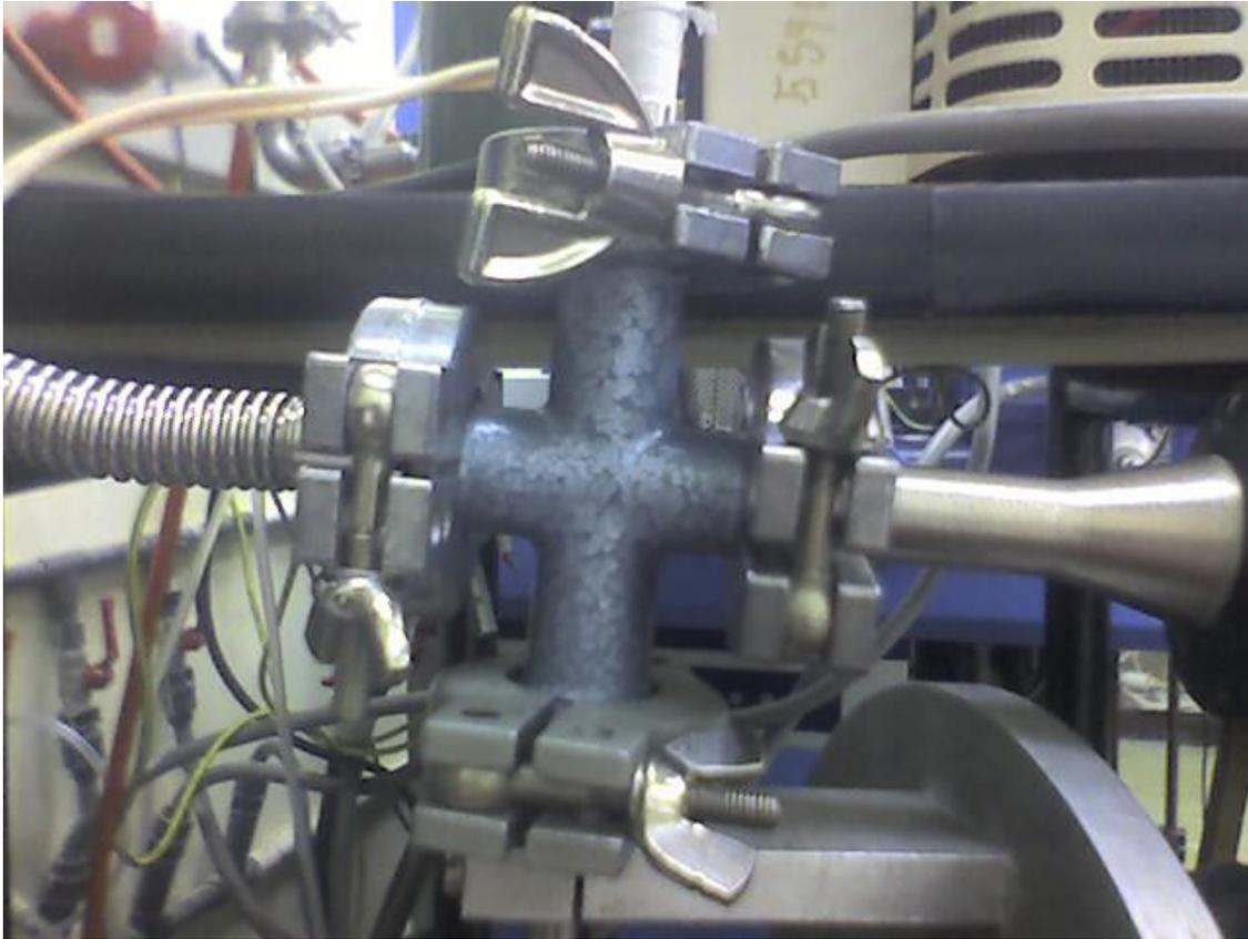
Figura 4.9. Esquema que indica la conexión del sensor de presión a la línea de vacío.
