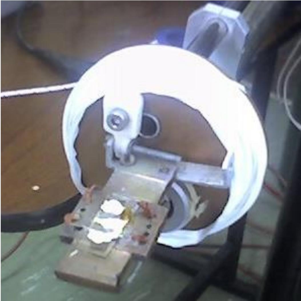
Figura 4.14. Portamuestras para ubicar el sensor semiconductor.
