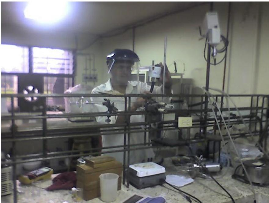
Figura 4.3. Montaje preliminar de un sistema de vidrio, para estructurar un equipo convencional a utilizar en la caracterización de potenciales sensores de gases.
