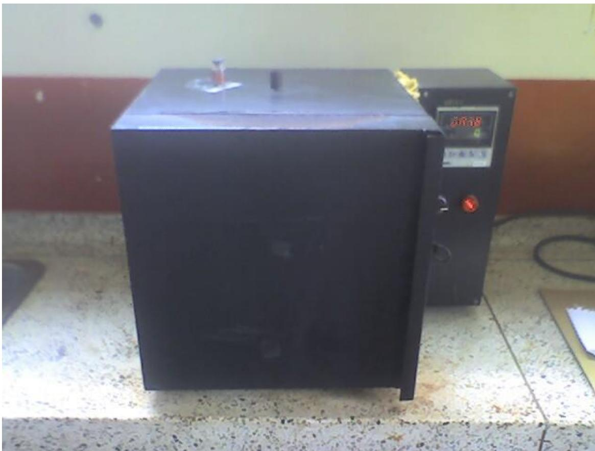
Figura 3.4. Horno utilizado para realizar el programa de calentamiento de la muestra precalcinaada obtenida por el método pechini.
