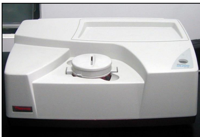
Figura 2.9. Espectrómetro de Infrarrojo (FTIR), marca Termo Nicolet IR200, utilizado en este trabajo.
