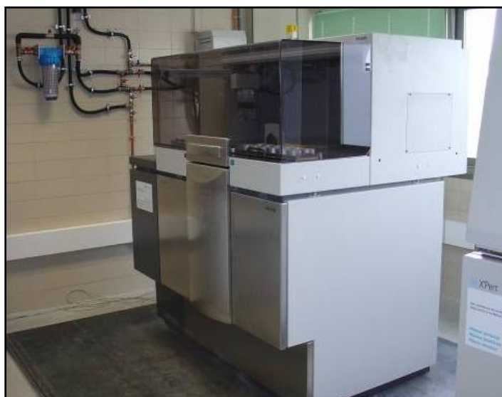
Figura 2.46. Espectrómetro de fluorescencia de rayos X (FRX) marca Philips MagiX Pro (Universidad Nacional de Colombia), utilizado en este trabajo.
