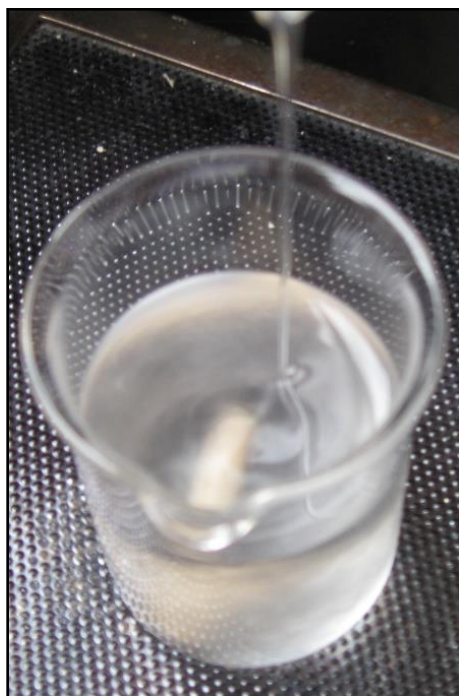
Figura 2.5. Montaje utilizado para que reaccione el alcohol con el precursor de titanio (TBT).
