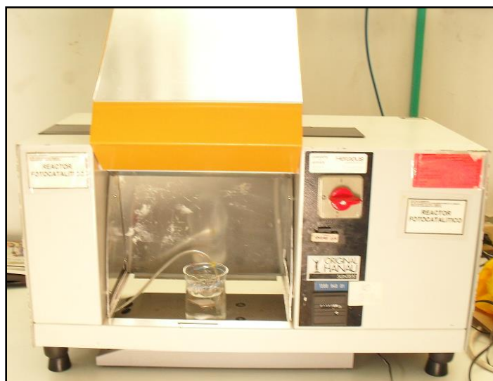
Figura 5.3. Reactor fotocatalítico, marca Original Hanau Suntest, utilizado en este trabajo (Laboratorio de Microbiología sanitaria del departamento de Ingeniería Química - Universidad del Valle – Cali).
