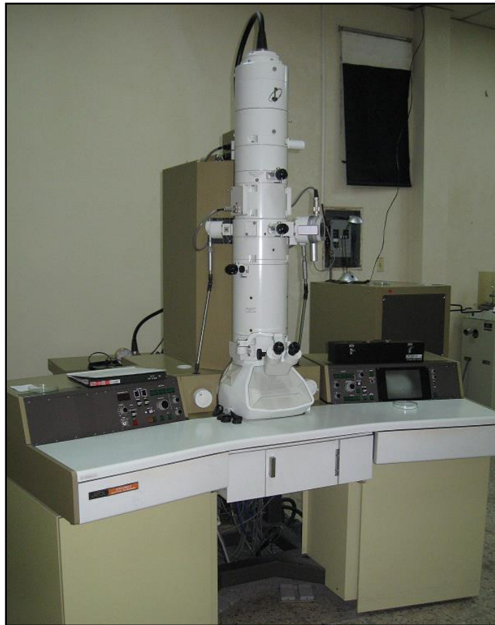
Figura 2.23. Microscopio electrónico de transmisión (MET), marca JEOL JEM-1200 (Unidad de Microscopía Electrónica – Unicauca), utilizado en este trabajo.
