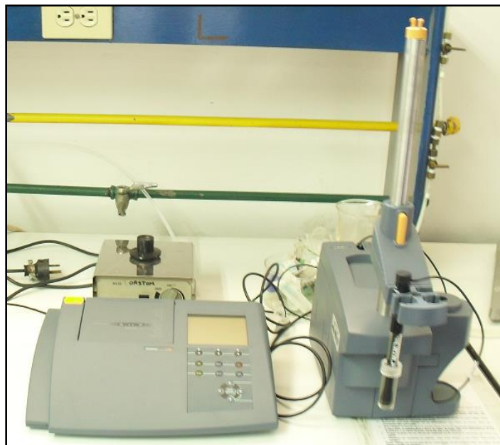
Figura 5.2. Potenciómetro de ión cloruro, marca Inolab WTW series terminal 740, utilizado en este trabajo (Laboratorio de Microbiología sanitaria del departamento de Ingeniería Química - Universidad del Valle – Cali).
