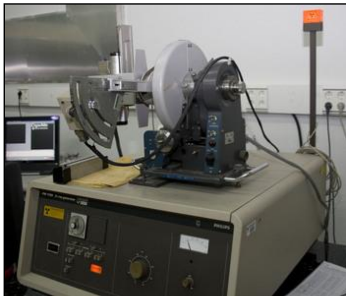
Figura 2.19. Difractómetro de rayos X (DRX), marca Philips PW1710, utilizado en este trabajo.
