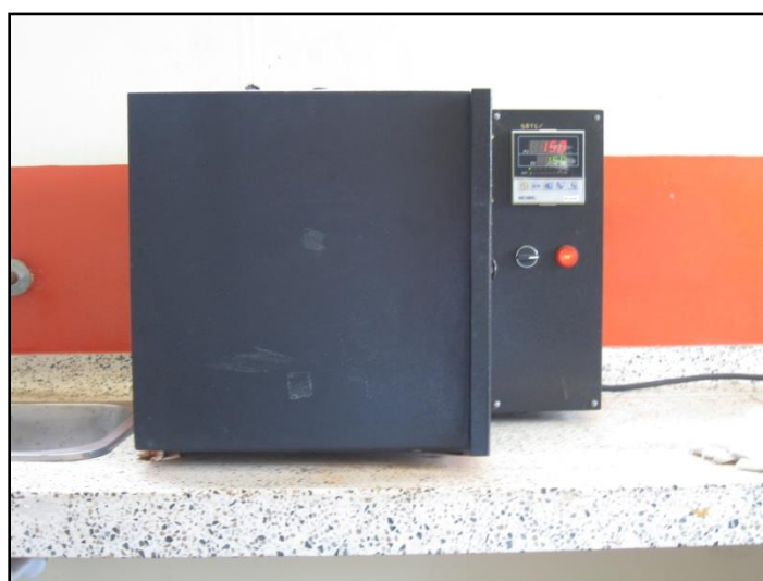
Figura 2.8. Horno utilizado para el tratamiento térmico de los polvos cerámicos, marca Maxthermo.
