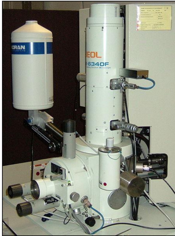
Figura 2.28. Microscopio electrónico de Barrido (MEB), marca JEOL JSM-6340F, utilizado en este trabajo.
