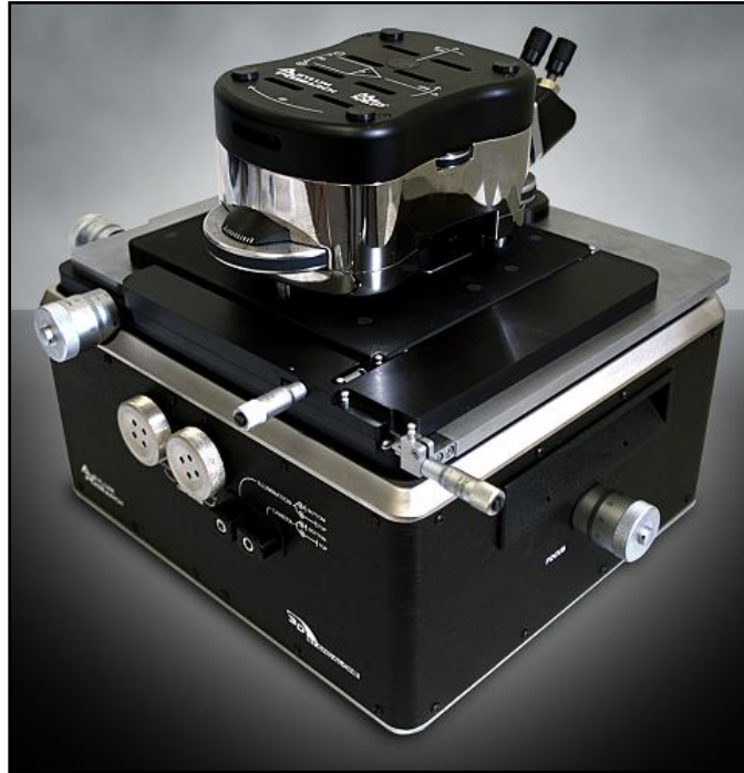
Figura 4.7. Microscopio de fuerza atómica (MFA), marca MFP-3D-3A, utilizado en este trabajo (Universidad del Valle).
