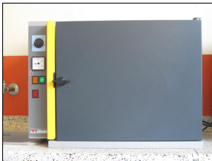
Figura 2.7. Horno utilizado para el secado de las muestras, marca Jouan EU28.
