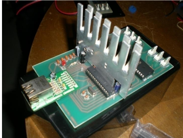
Imagen 16 - Detalle del Disipador de Calor Instalado
