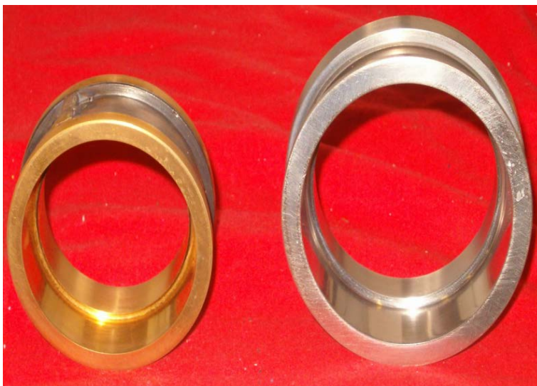
Figura 7.4 Fotografía de dos piezas recubiertas con TiN y CrN, respectivamente
