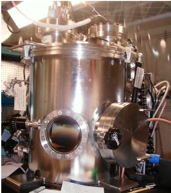
Figura 7.5: Imagen del Magnetron Sputtering perteneciente al Laboratorio RDAI de la Universidad del Valle.
