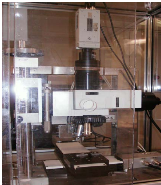
Figura 7.6 Imagen del Nanoindentador NANOVEA, perteneciente al laboratorio de recubrimientos duros de la Universidad del Valle. Este equipo se encuentra acoplado a un PC con un software desarrollado para su funcionamiento
