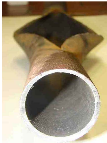
Figura 8.14: El desgaste corrosivo ha generado en el tubo pérdida de material. La zona por donde se presenta la corrosión ha colapsado y ha provocado un rompimiento del material.
