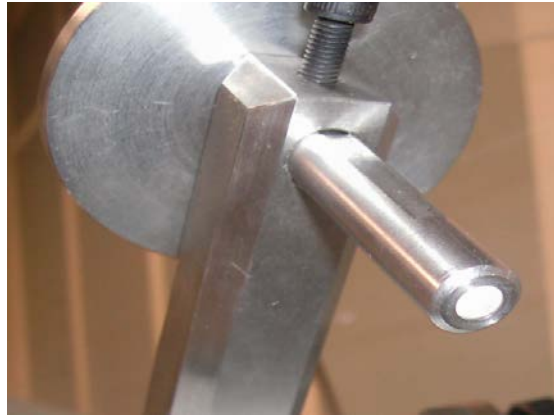
Fotografía 7.11: El material de la bola acoplada al equipo para este ensayo, es alúmina.
