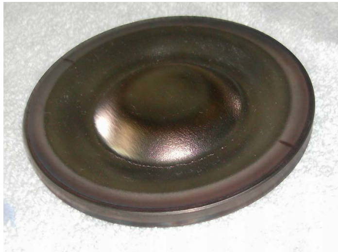
Figura 7.3: Imagen de un Blanco de Titanio, utilizado para generar recubrimientos de TiN, TiNC, TiAlN, etc.
