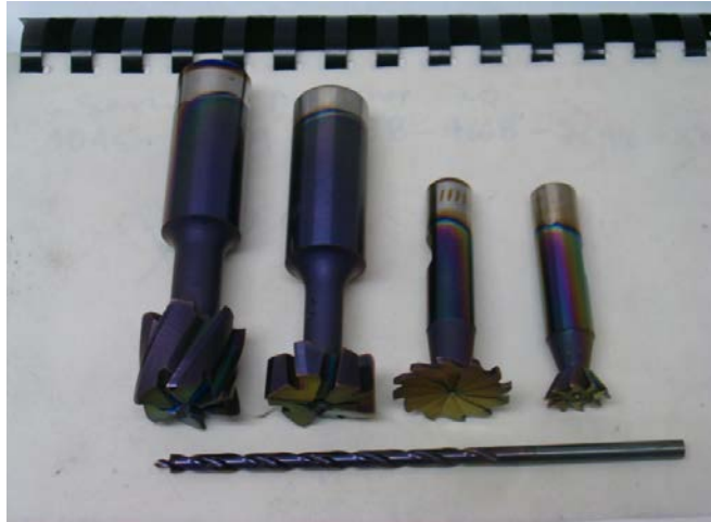
Figura 2.2 Fresas recubiertas con Nitruro de Titanio Aluminio (TiAlN) [3]
