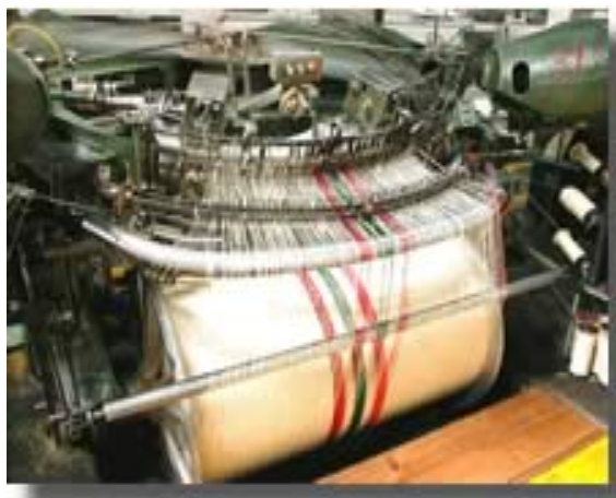
Figura 8.3: Telar, máquina que teje la tela de acuerdo con las distintas especificaciones y referencias.
