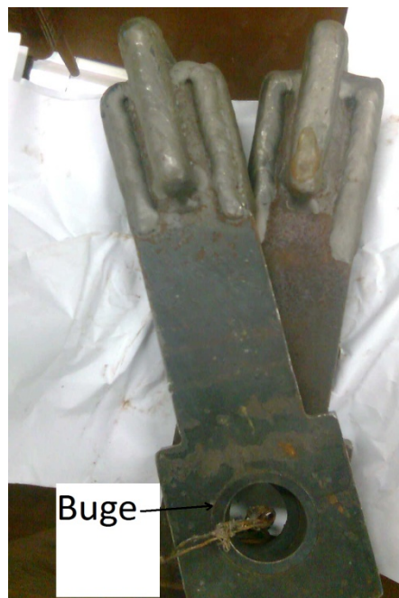
Figura 8.13: Cuchillas ventiladoras recubiertas con WH 70, mediante un proceso de soldadura metalizada. Si después de retiradas las cuchillas del desmedulador, no han perdido su forma original, estas se pueden recubrir nuevamente y reutilizarlas. Si el desgaste es muy fuerte, solo se recuperará el buge, soldando una nueva cabeza recubierta.
