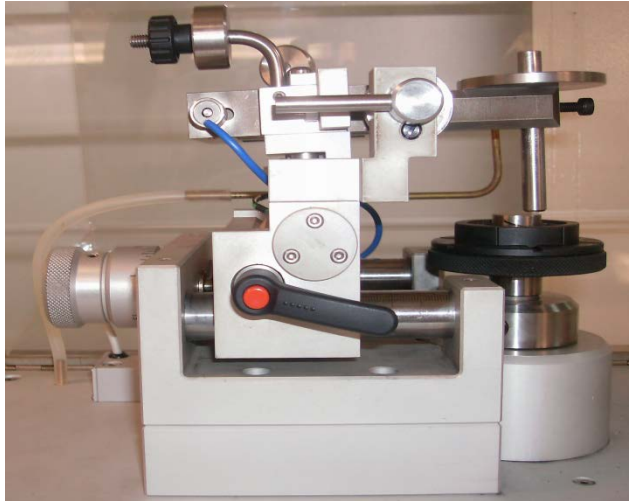
Fotografía 7.10: Imagen del Equipo Ball on disk perteneciente al laboratorio de Recubrimientos Duros de la Universidad del Valle. La pieza sobre la cual se realiza la prueba se encuentra acoplado al equipo.
