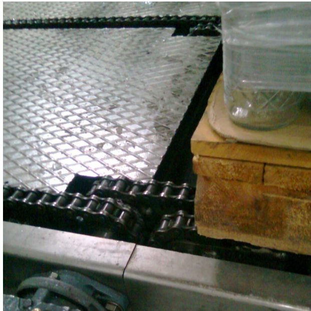
Figura 8.11: Rodillos encargados de soportar el peso de las cadenas transportadoras de los paños de botellas vacías
