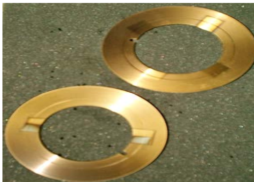
Figura 2.1 Cuchilla utilizadas en el corte de papel, recubiertas con Nitruro de Titanio (TiN) [3]
