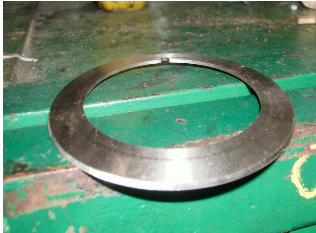
Figura 8.5: Cuchilla de corte de papel, sin recubrir, utilizada en el proceso manufacturero de la empresa COPAPEL S.A.
