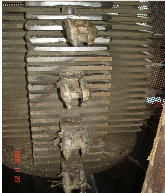
Figura 8.12: Se puede observar la disposición de las cuchillas ventiladoras en el desmedulador. En el impacto de las cuchillas al bagazo, se desprenden las cenizas e impurezas que salen del tambor atravesando el tamiz que se observa al fondo en la fotografía.
