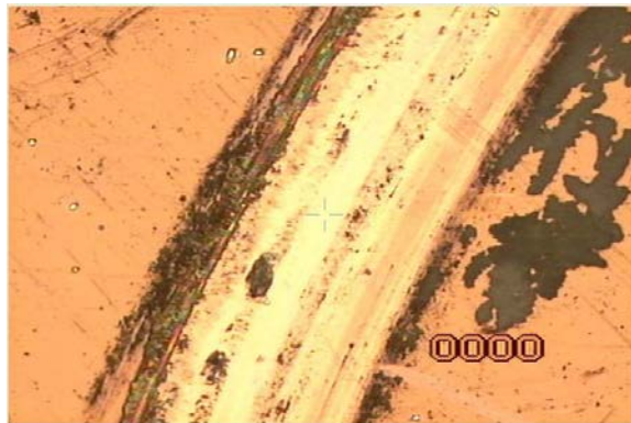
Figura 7.13: Resultado de un análisis microscópico de las huellas dejadas en la película por el ensayo de coeficiente de fricción. Las marcas negras en los bordes de la marca corresponden al debris desprendido durante la prueba. En muchos casos estos residuos se analizan para conocer si corresponde al recubrimiento, a la bola o es unión de los dos.
