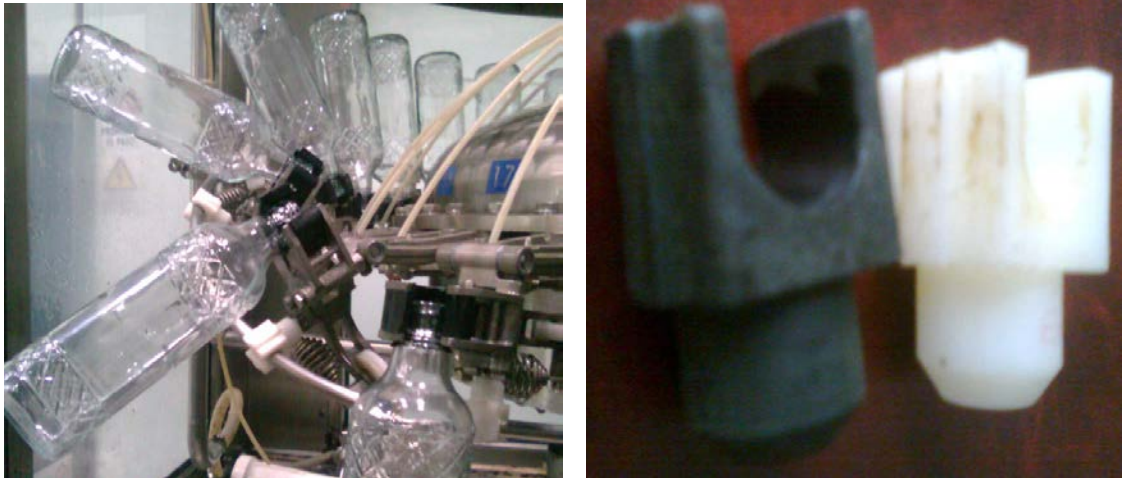
Figura 8.8: (a) Maquina encargada del lavado de las botellas. Se observan las piezas blancas de polietileno, las cuales sufren un fuerte desgaste (b) Piezas de polietileno
