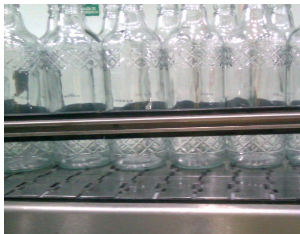
Figura 8.9: Cadenas lubricadas que realizan el transporte de botellas vacías en la Industria Licorera del Cauca
