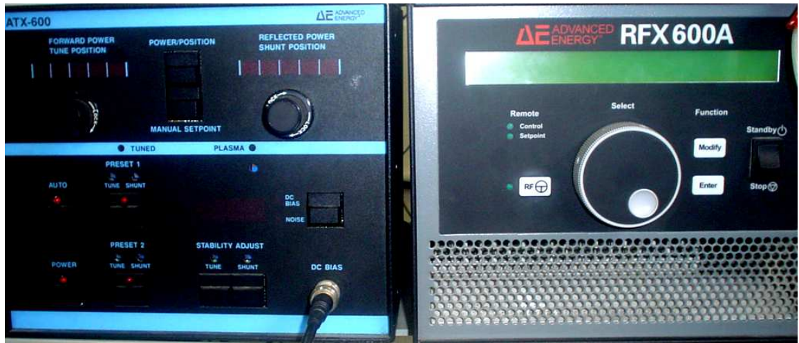
Figura 5.7 Sintonizador de Radio Frecuencia ATX-600 y Fuente Emisora de Radio Frecuencia RFX – 600A
