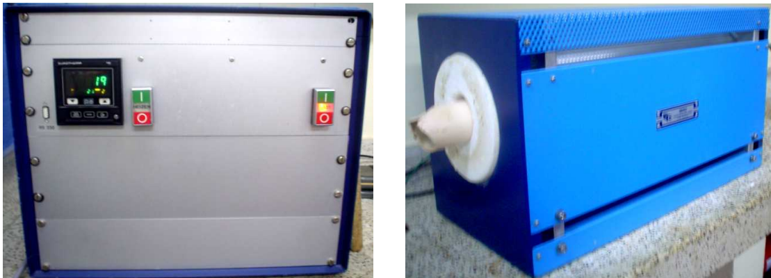
Figura 5.21 Horno de fabricación alemana con controlador de temperatura de alta precisión Eurotherm .
