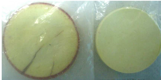
Figura 5.6 Blanco de Óxido de Zinc Sinterizado en Atmósfera de Aire.
