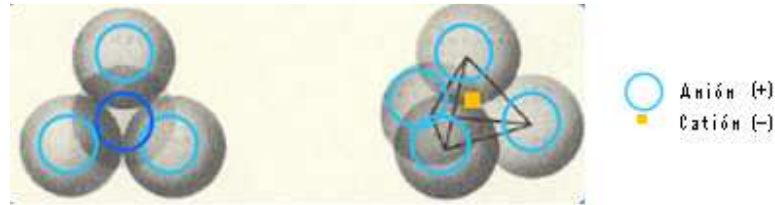
Figura 2.4 Construcción de un sitio intersticial tetraédrico, en una estructura de empaquetamiento compacto.
