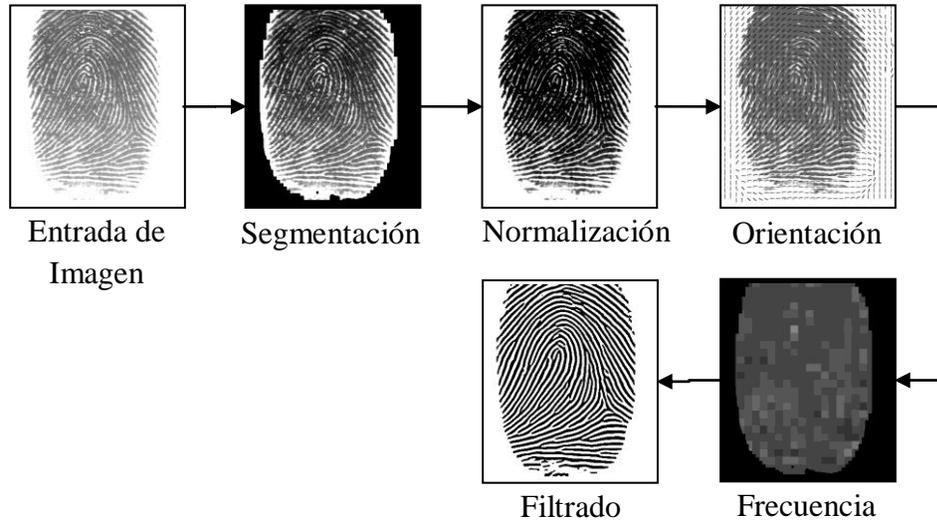
**Figura 11.** Diagrama de flujo para el mejoramiento de las huellas dactilares.
