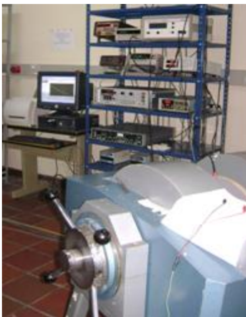
Figura 3.13: Sistema de medición y adquisición de datos de RT, MR y curvas de IV.
