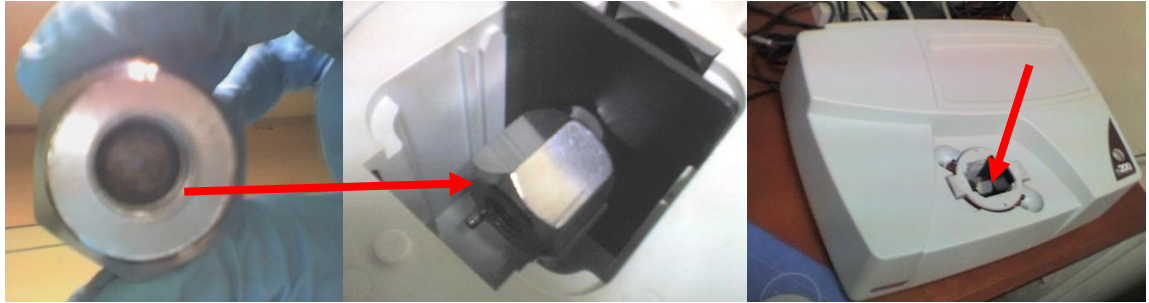
Figura 3.11: Preparación de las muestras y montaje de las muestras en el equipo de espectrometría infrarroja.
