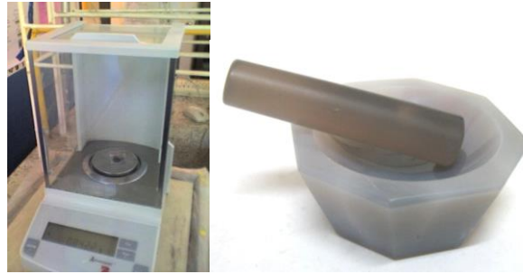
Figura 3.1: Báscula cerrada (4 cifras significativas) y mortero de ágata.
