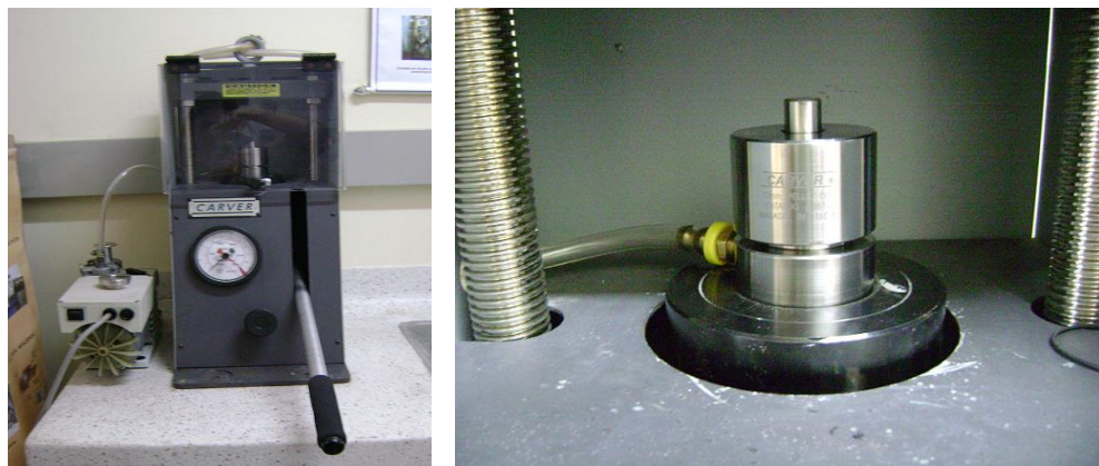
Figura 3.2: Prensa CARVER de hasta 11 Ton.
