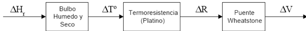
Figura 1.7 Diagrama de flujo de un sistema de medición de humedad con bulbo húmedo y seco
