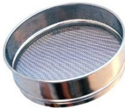
**Figura 2.14.** *Tamiz malla  $60\mu\text{m}$ , utilizado durante el proceso de tamizado de la arcilla caolinítica natural.*
