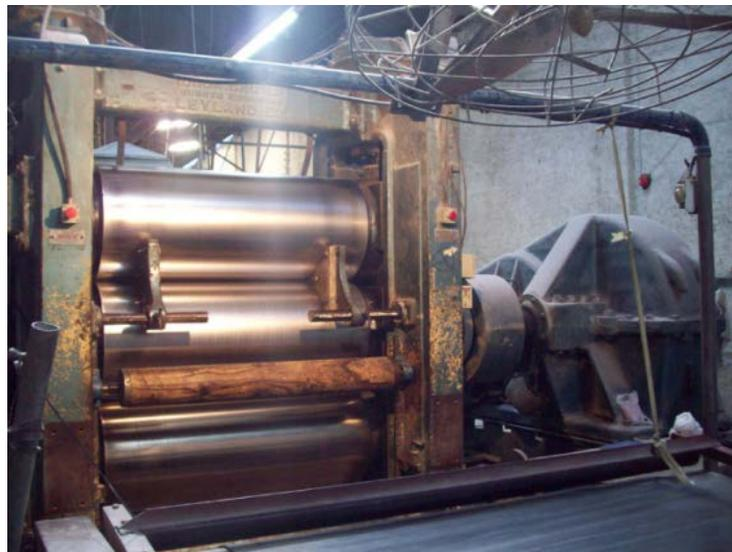
*Figura 5.5. Calandra de tres rodillos utilizada para la incorporación de la lona al caucho.*
