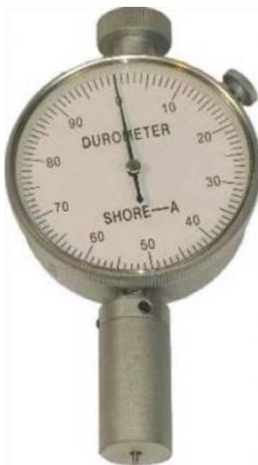
*Figura 5.15. Durómetro “Shore A” utilizado para determinar la dureza de los cauchos.*
