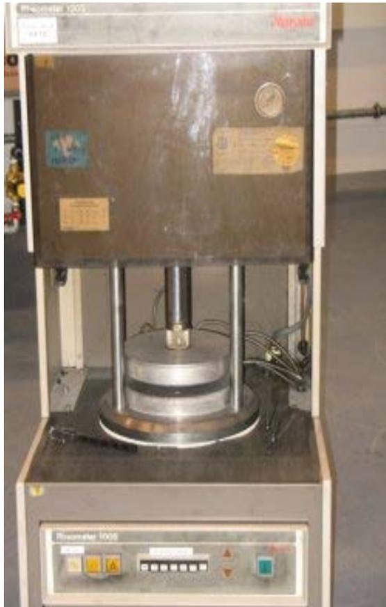
**Figura 5.7.** El Reómetro Marca Monsanto 100S, que se utilizó para realizar los ensayos de reología de las muestras.
