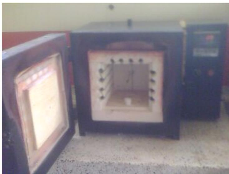
*Figura 3.2. Cámara del horno Maxtermo utilizado para realizar el tratamiento térmico de las muestras de arcilla caolinítica de interés.*
