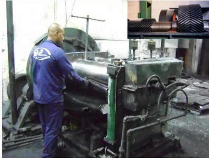
*Figura 5.4. Proceso de mezclado para la fabricación de las mezclas de caucho.*
