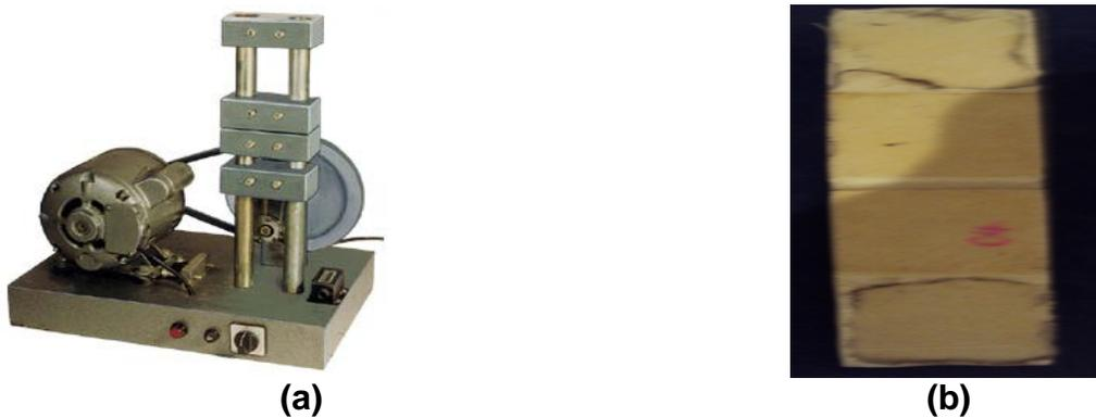
**Figura 5.16.** Prueba de flexión: (a) Flexómetro de De Mattia, y (b) Probeta utilizada para realizar las pruebas.
