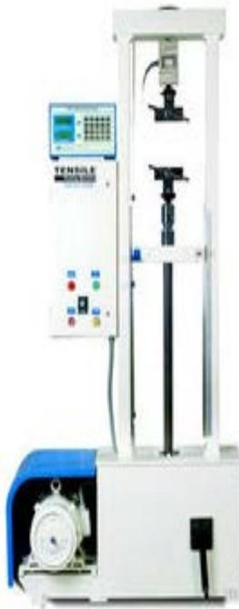
**Figura 5.11.** Máquina universal que se utilizó para realizar las pruebas de elongación y desgarro.
