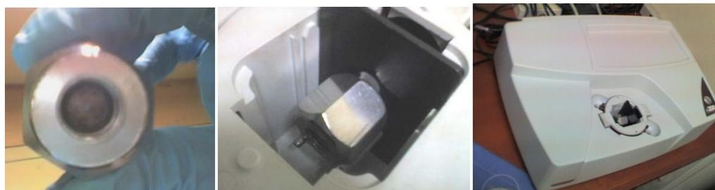
**Figura 2.16.** Preparación de la muestra y montaje de la misma en el equipo para obtener su espectro IR.
