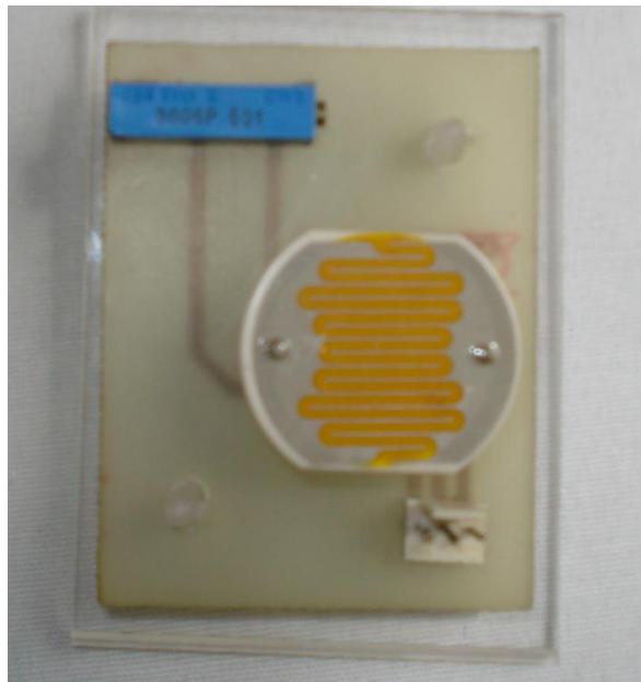
Figura 17. Montaje del sensor de iluminancia
